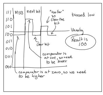
FIGURE 7 A TABLET FIGURE SHOWING ADC OPERATION
